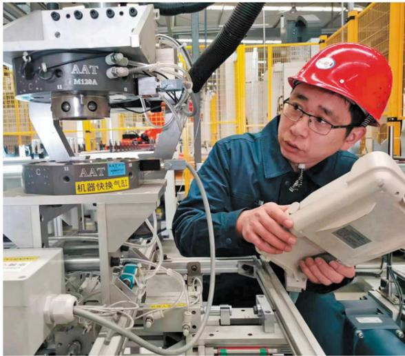
加工中心调试过程中，工装气密检查装置表面经常会有细小铁屑，从而导致机床气密报警。郝小虎利用机床中心的出水功能，在程序中增加了清洗气密面的工序，彻底解决了该问题。他运用所学的专业知识，为有效把控现场设备的异常状态和生产的高效安全建言献策，他的多条建议被相关岗位和部门吸收和采纳，得到了领导和同事们的一致好评。
