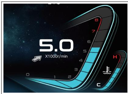
转速表显示发动机在每分钟内的转速。转速的单位是 r/min(转 / 分钟)，发动机转速范围是 0~8000r/min，危险转速范围是 7000~8000r/min。
