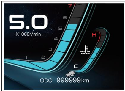
水温表显示发动机冷却液的温度。在 C~H 的指示范围内共有 8 段刻度指示，其中“C”表示冷（低温），“H”表示热（高温），根据不同温度点亮相应的格数。当水温表点亮第 7 段刻度指示时，表示发动机冷却液温度过高（温度大于等于 116°C），仪表内的发动机冷却液温度过高报警灯
