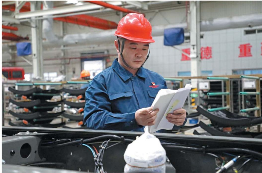
个细节——损坏时间、部件接触点、工人操作习惯。又带着观察数据和图纸找到技术人员：“你看，发动机落装时，后悬架胶块会撞击TB阀，这是损坏主因。把阀体往左上移3厘米，利用现有夹具微调就能实现。”技术人员却皱起眉头：“改动涉及多个工序，生产线难度和风险太大。”刘继宗不急不躁，拿出模拟试验的数据：“咱们小规模试试，有这些数据支撑，不会出大问题。”在他的坚持下，工艺部门尝试改进，经过上百次发动机落装验证，不断优化改进方案。实施新方案后装配效率大幅提升，阀体损坏率从0.8%降至0.05%。每年可节省工时166小时，降低人工成本约5.6万元；同时形成“观测-分析-验证-推广”的标准化改善方法，推动同类工位效率平均提升6.2%，成为一线工艺优化改善的“秘籍”。
