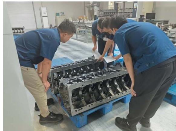
上线与轴承套存在干涉问题,进一步保障了凸轮轴孔加工尺寸满足工艺要求,顺利完成设备修复工作。整体节约制造费用80余万元。
